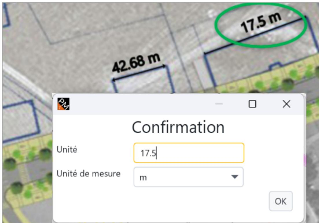
Les mesures de longueur de l'autre bâtiment et de largeur de voie sont automatiquement ajustées :
